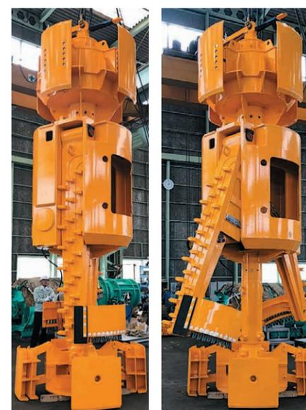
▲E・Rockビット(振れ止め装着時)
