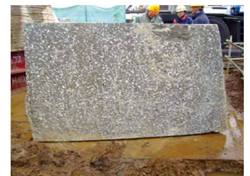
▲カットした杭体面 ※確実にコンクリートが充填されていることが観察できます。
